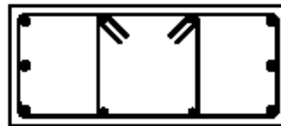
B 30 \times 70 6\varnothing 20 + 4\varnothing 14
