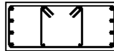
C 30 \times 70 8\varnothing 20 + 4\varnothing 14
